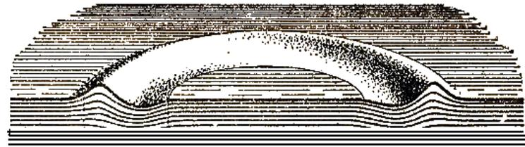
Будем освещать эти круговые волны лампой, расположенной сверху над кюветой. Свет, проходя толщу воды, попадает на экран, расположенный снизу под кюветой. На экране возникает тeneвая движущаяся картина волн.
